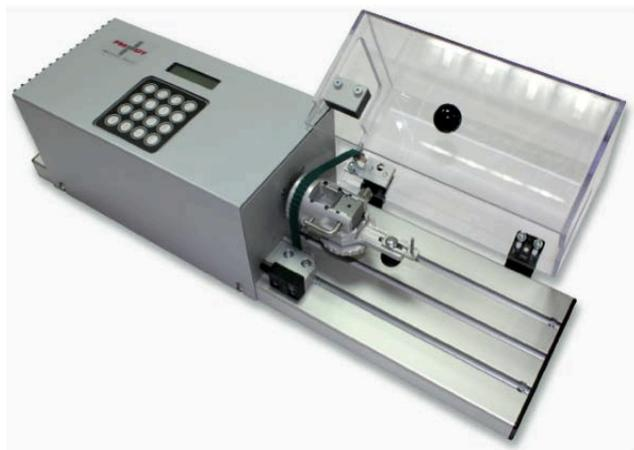
Оборудование PRO Twist Basic A/B предназначено для скручивания двух изолированных, опрессованных, одиночных кабелей или одиночных кабелей с уже установленными уплотнителями. Оборудование имеет 99 программируемых конфигураций, включая регулируемое количество оборотов, плоский захватывающий механизм со специальным покрытием (щадящий захват). Для обработки проводов различных сечений замена инструмента не требуется.
