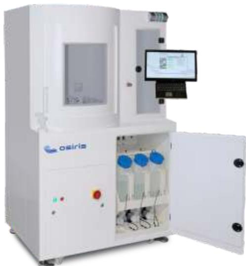
**Установка Osiris CHEMIXX Mask30 предназначена для отмытки фотошаблонов размером до 9x9" и полупроводниковых пластин диаметром до 300 мм.**
